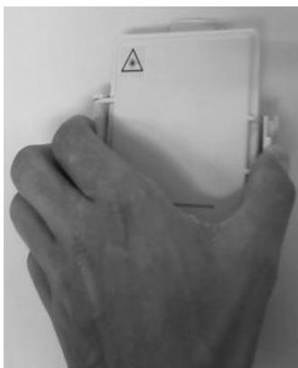
2. Fixar o suporte na parte traseira da PTO-R até encaixar e travar. Colocar no parafuso da roldana e prender.
